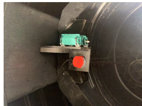
Bild 3: Gelkopplingar. Vattenpump och nivågivare ansluts i tanken med dessa och fästs med buntband på de små vita fästen som sitter där.
