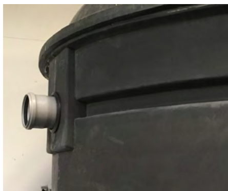
Bild 4. Inkommande rör till ProACT® från huset görs med standard 110 mm avloppsrör. OBS: Vrid ej inloppsröret i tanken.
