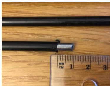
Bild 15: Avskalning av nivågivarna.
